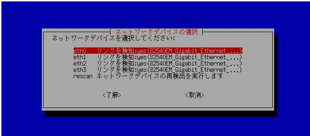
(2) (1)の画面において、Alt と F2 キーを同時に押してコンソール画面に移る。
