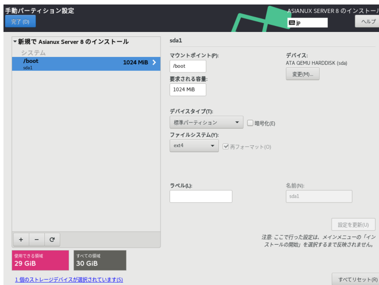
図 4-24 標準パーティションによる構成例 (/boot)
